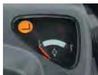
Контрольная лампа блокировки подъема на панели приборов
