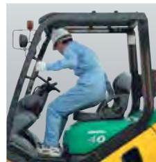
Когда оператор покидает свое сиденье, включается система определения присутствия оператора на рабочем месте (OPS)
