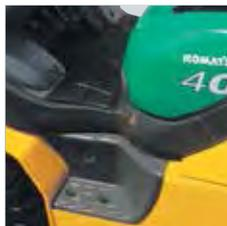
Улучшенная конструкция капота двигателя и подножки
