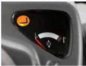
Включение блокировки также отображается на панели управления.
