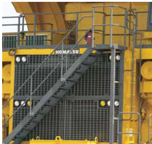
Вход на лестницу доступа в кабину самосвала Komatsu 960E-2K может быть предусмотрен как с правой, так и с левой стороны, что определяется выбором заказчика.
