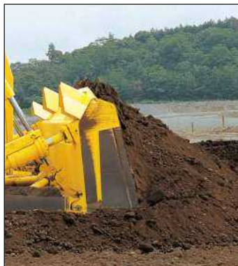
Полусферический отвал с изменяемым углом перекоса
