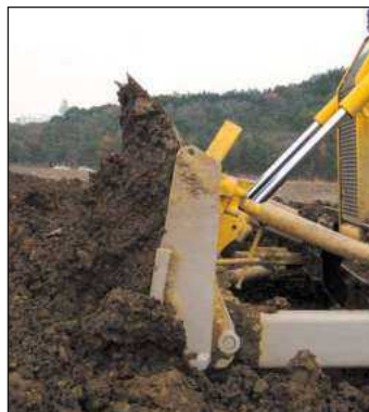
Отвал с регулируемым перекосом (D65-15E0)
