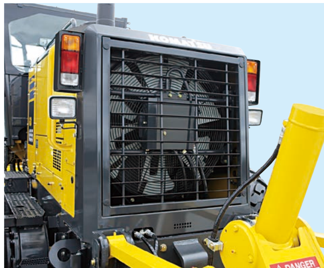
Работающий от гидропривода вентилятор радиатора
