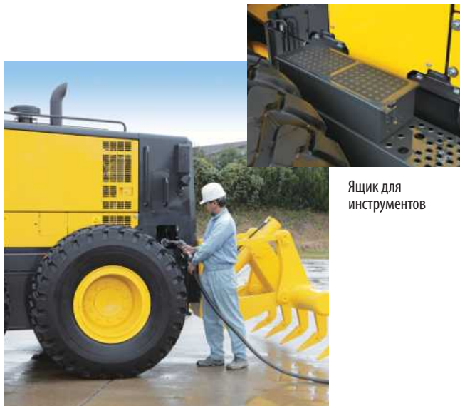
Дозаправка топливом доступна с уровня земли
