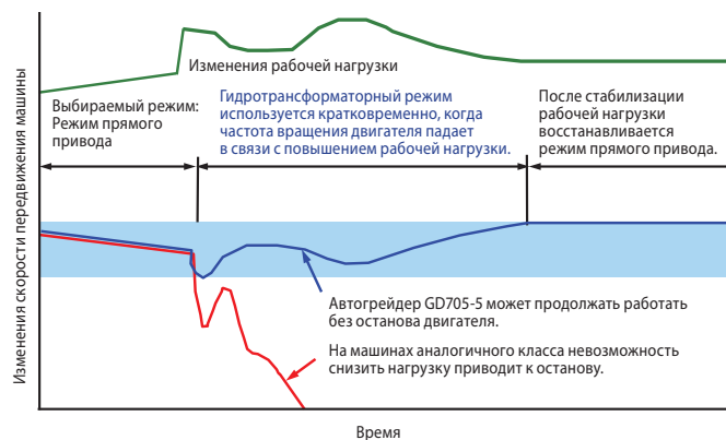
Условия управления коробкой передач GD705-5
