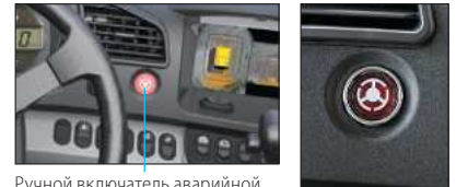
Ручной выключатель аварийной системы рулевого управления
