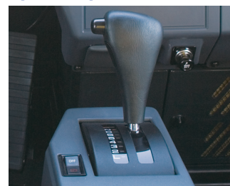
K-ATOMICs (Усовершенствованная коробка передач Komatsu с системой управления оптимальной модуляцией)
