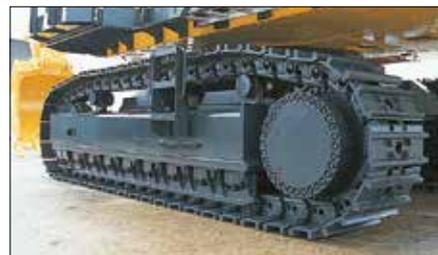
**Защитный щиток опорных катков (на всю длину) (по дополнительному заказу)**
