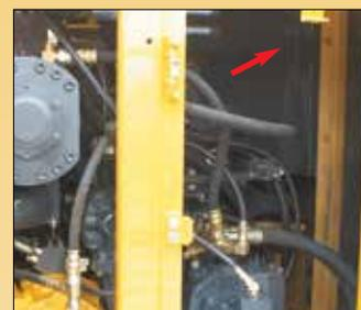
**Данные ограждения** устанавливаются вокруг сильно нагреваемых частей двигателя и привода вентилятора.
