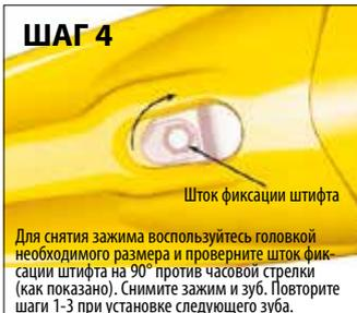
Для снятия зажима воспользуйтесь головкой необходимого размера и проверните шток фиксации штифта на 90° против часовой стрелки (как показано). Снимите зажим и зуб. Повторите шаги 1-3 при установке следующего зуба.
