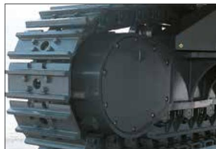
**Прочные ограждения** защищают двигатели хода и трубопроводы от повреждений о скальный грунт.
