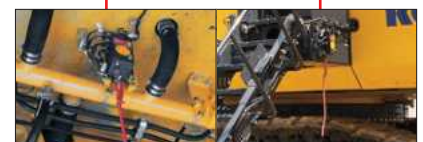
Кнопки аварийной остановки двигателя
