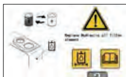
Предупреждение о засорении масляного фильтра гидравлической системы
