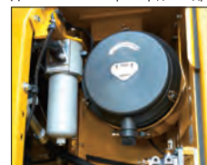
Дополнительный фильтр для гидромолота
