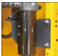
Масляный фильтр двигателя
