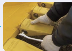
Установить втулку, шайбу и болт и затянуть трехточечным ключом
