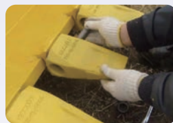
Вставить вынутый палец в отверстие для штифта адаптера
