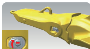
Повернуть вал блокировки пальца на 90° против часовой стрелки для блокировки зубьев
