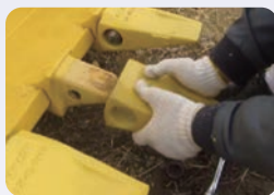
Установить PAB зуб на горизонтальный штифтовой адаптер
