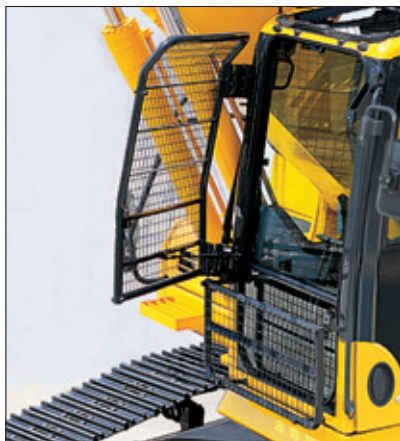
Переднее защитное ограждение кабины на полную высоту, уровень 1 (ISO 10262)
