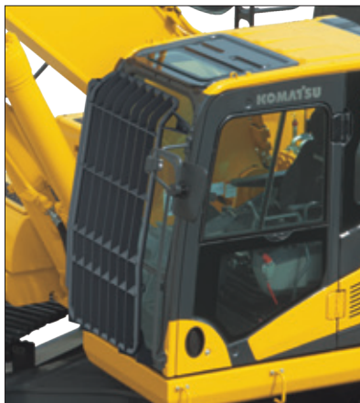
Переднее защитное ограждение кабины на полную высоту, уровень 2 (ISO 10262)
