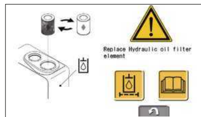
Предупреждение о засорении масляного фильтра гидравлической системы
