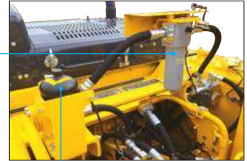
Дополнительный фильтр для гидромолота с датчиком засорения
