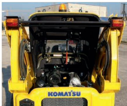
Капот: быстрая проверка двигателя
