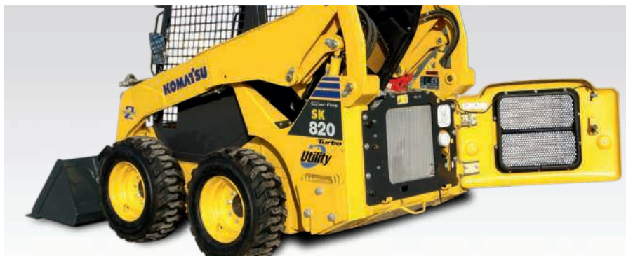
Задняя дверь: удобная проверка и очистка радиаторов
