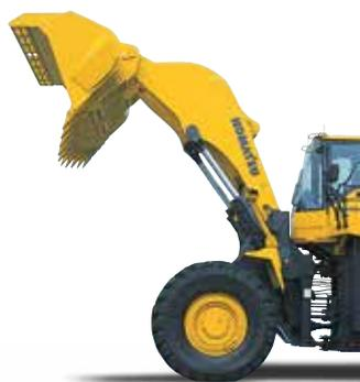
Погрузчики серии WA600 со стандартной стрелой рассчитаны на загрузку самосвалов грузоподъемностью 60 тонн (70 коротких тонн). На модели WA600-3 требуется установка стрелы с большим подъемом и ковша вместимостью 6,4 м<sup>3</sup>. Благодаря увеличенной высоте кабины модели WA600-6 оператор имеет отличный обзор при выполнении погрузочных работ.
