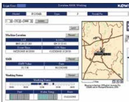
**Рабочее время машины –** Используя ежедневную запись работы, определите точное время работы двигателя: время, когда он был включен и остановлен, а также общее время работы двигателя.
