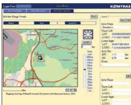
**Повышенный уровень безопасности –** Функция «блокировка двигателя» позволяет задавать момент запуска двигателя машины. А используя функцию «область наблюдения», система Komtrax посылает уведомления каждый раз, когда ваша машина с той или другой стороны пересекает предварительно заданные границы рабочей зоны.
